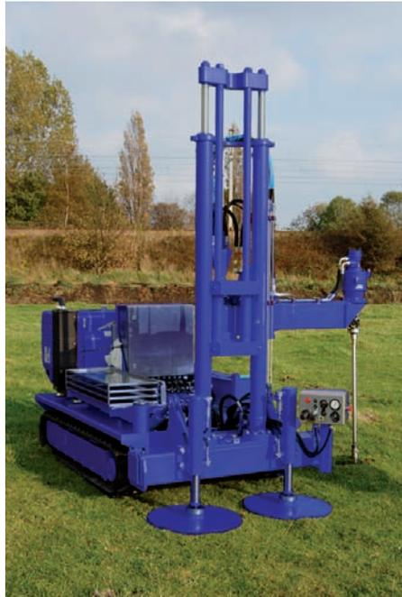
Drucksondier-Anlage Griffin 200 kN von BauGrund Süd
