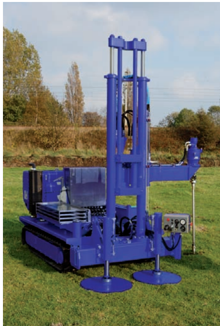
Drucksondier-Anlage Griffin 200 kN von BauGrund Süd
