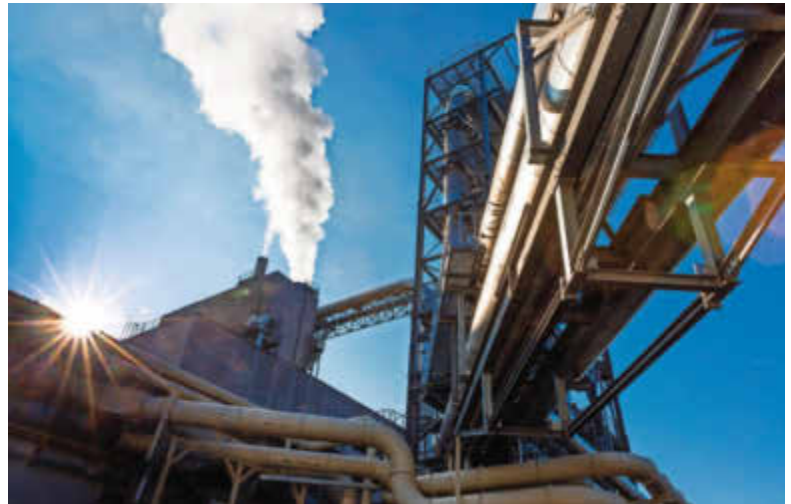
Einblicke in die Produktion bei Gutex: Die im Trockenverfahren hergestellten Dämmplatten werden zugeschnitten (linke Seite); einen Überblick über die Produkte von Gutex liefert das Bild oben links. Rechts daneben ist zu sehen, wie der beim Trocknen der Hackschnitzel entstehende Wasserdampf über dem Werksgelände entweicht.
