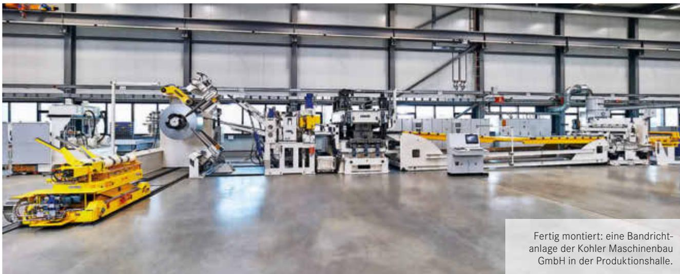
Fertig montiert: eine Bandrichtanlage der Kohler Maschinenbau GmbH in der Produktionshalle.
