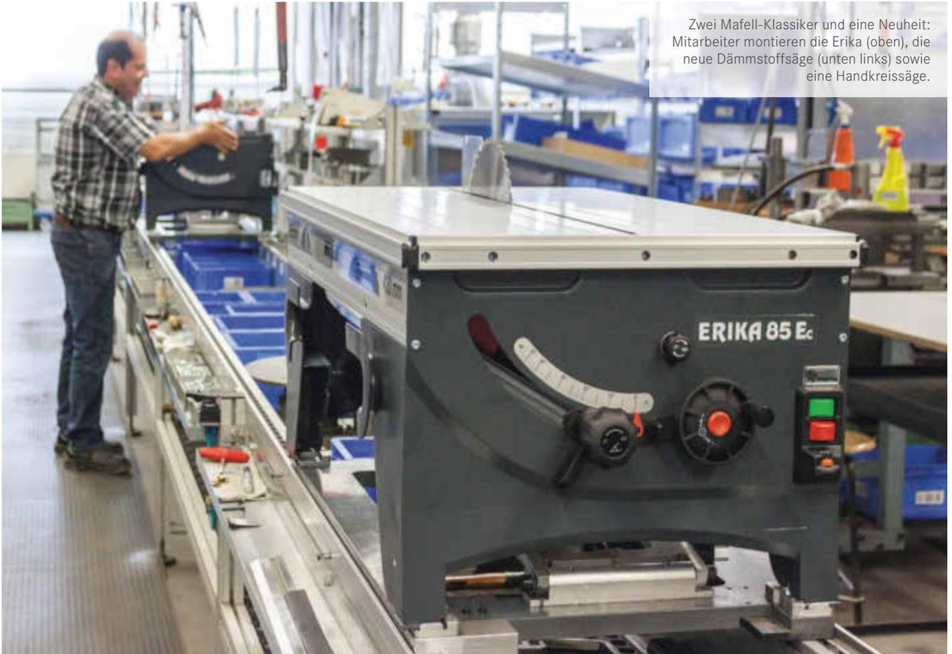
Zwei Mafell-Klassiker und eine Neuheit: Mitarbeiter montieren die Erika (oben), die neue Dämmstoffsäge (unten links) sowie eine Handkreissäge.
