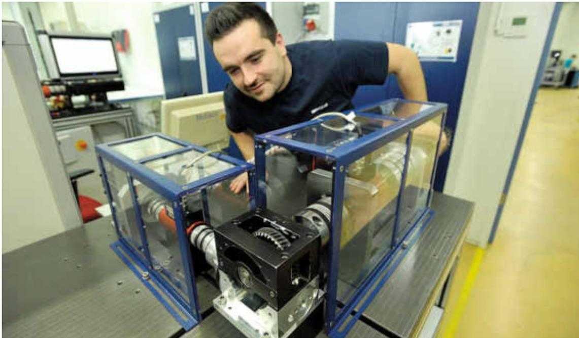
Ein Prüfstand für Schneckenräder im Labor von IMS Gear. Die Schneckenräder kommen in elektromechanischen Servolenkungen zum Einsatz.
