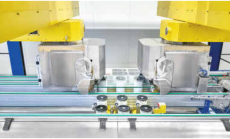
Produktion bei Schafheutle Glassolutions in Freiburg: ein Schleifaggregat mit Topfscheiben.
